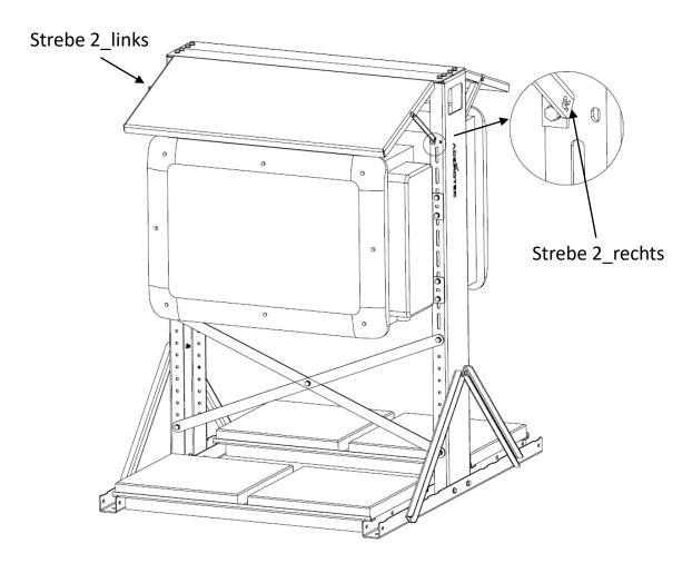
Alle vier Streben (Markierung L und R beachten) montieren, ausrichten und Schrauben mit 6 Nm anziehen.
