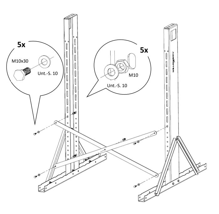
Schrauben handfest anziehen, Endanzug erfolgt nach Montageschritt 4 (Ausrichten).
