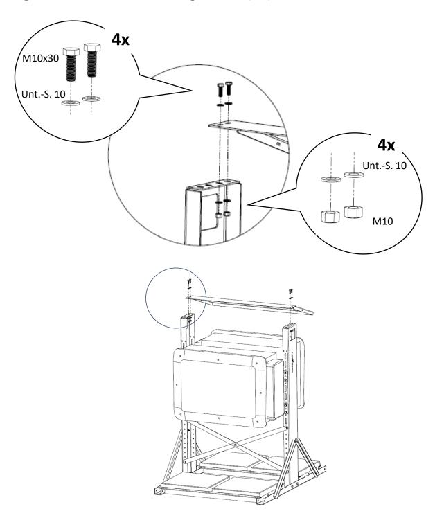
Beide Dächer montieren, Schrauben mit 30 Nm anziehen.
