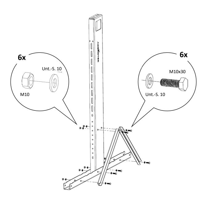
Schrauben handfest anziehen, Endanzug erfolgt nach Montageschritt 4 (Ausrichten).
