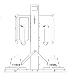
Das Ballastierungsgewicht muss über die Bodenschiene ragen.
