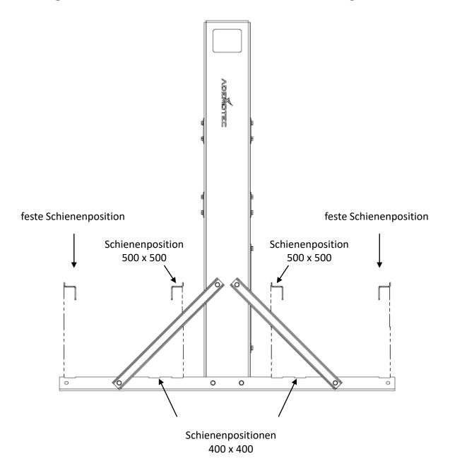
Ballastschienen auf Rastermaß der Ballastierung (Gehwegplatten) einstellen.
