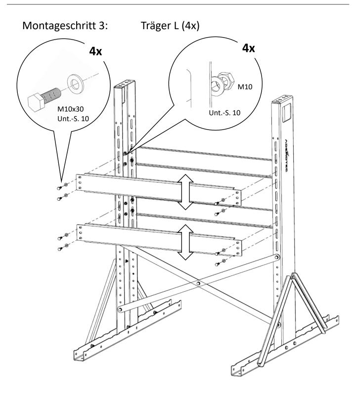
Höhe und Abstand der Träger auf die Wechselrichterposition abstimmen (siehe Montageanleitung Hersteller). Schrauben handfest anziehen, Endanzug erfolgt nach Montageschritt 4 (Ausrichten).
