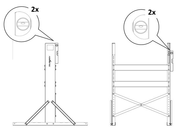
Beide Ständer mit der Wasserwaage ausrichten und alle Schrauben mit 30 Nm anziehen.
